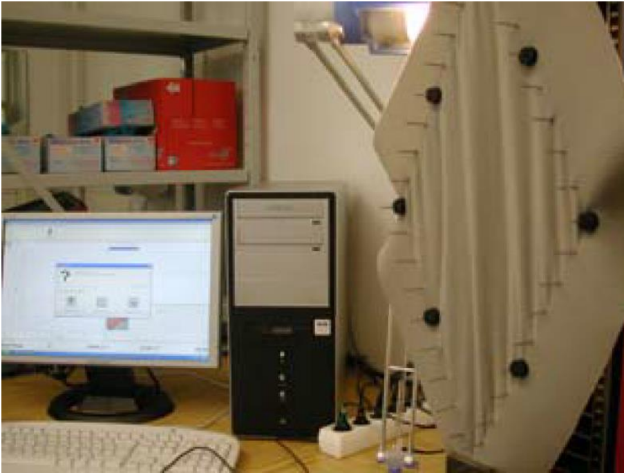
Abbildung 13: Scherrahmen; Quelle: Hoher Vliesstofftage (07. – 08.11.2007), Präsentation von: Prof. Dr. Ing. habil Hartmut Rödel, Folie 26; www.hoher-vliesstofftage.de/vortraege/2007/2007-09.pdf
