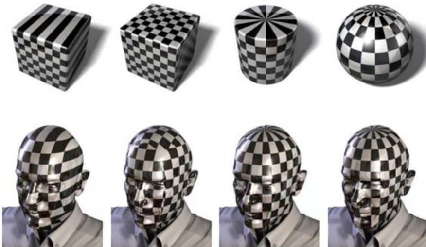
Abbildung 3: Standard-Mapping, angewendet auf eine Kopfgeometrie (Flächen-, Quader-, Zylinder- und Kugel-Mapping); Quelle: Schröder 2012, Diplomarbeit "Realismus bei der 3D-Charaktermodellierung des Menschen" S. 27
