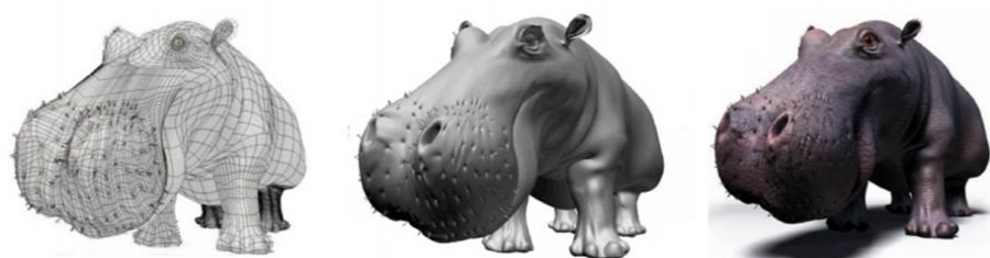
Abbildung 9: Vom Polygongitternetz zur detaillierten Darstellung. Das Modell (links) nach dem Shading (Mitte) Details der Hautstruktur, Farbnuancen und weitere Details werden durch Texturen hinzugefügt; Quelle: http://www.mttcs.org/Skripte/Pra/Material/vorlesung8.pdf
