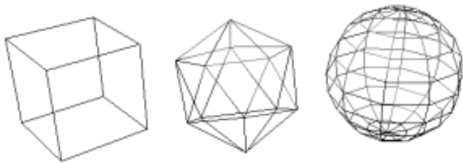
Abbildung 2: Drahtgittermodell eines Würfels, Ikosaeders und einer angenäherten Kugel; Autor: Wapcaplet; Quelle: https://de.wikipedia.org/wiki/Drahtgittermodell#/media/File:Wireframe2.png
